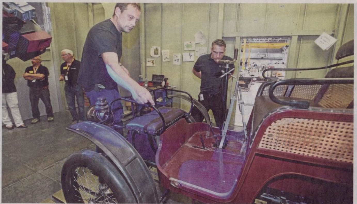
Die Mitarbeiter Christian König (links) und Marcus Wolf versehen den Motorwagen in der Messzelle im Werk Eisenach der BMW Group mit Orientierungspunkten für den 3D-Scanner. In dem blauen Licht sind feine parallele Licht-Streifen, die die Abtastung erleichtern.
